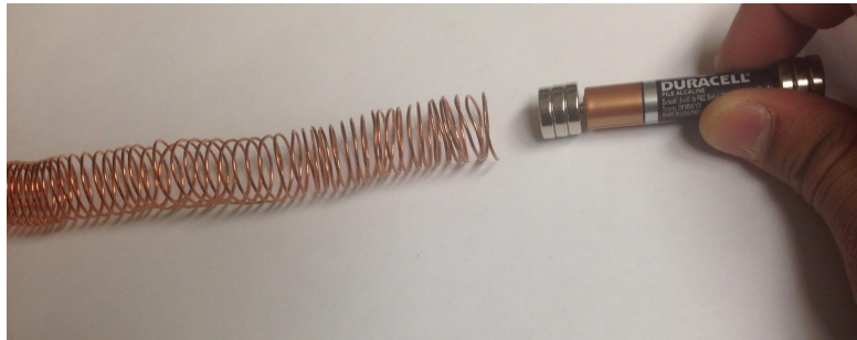
Figura 1: Pista del solenoide terminado y el tren de la batería
